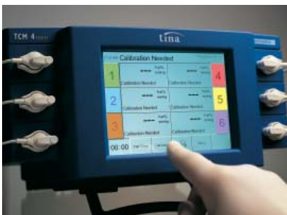
Pantalla táctil. Calibración de todos los electrodos tan sólo pulsando un botón.
